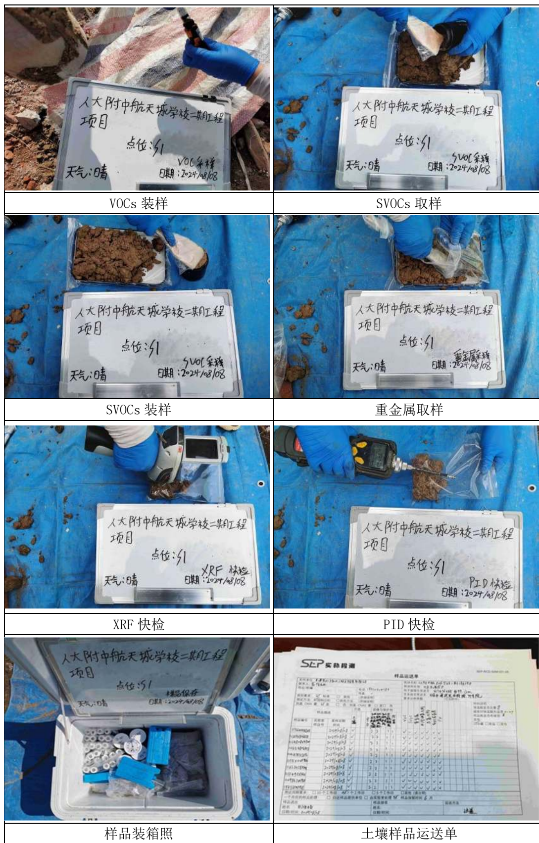
图 4-4 土壤采样现场照片
