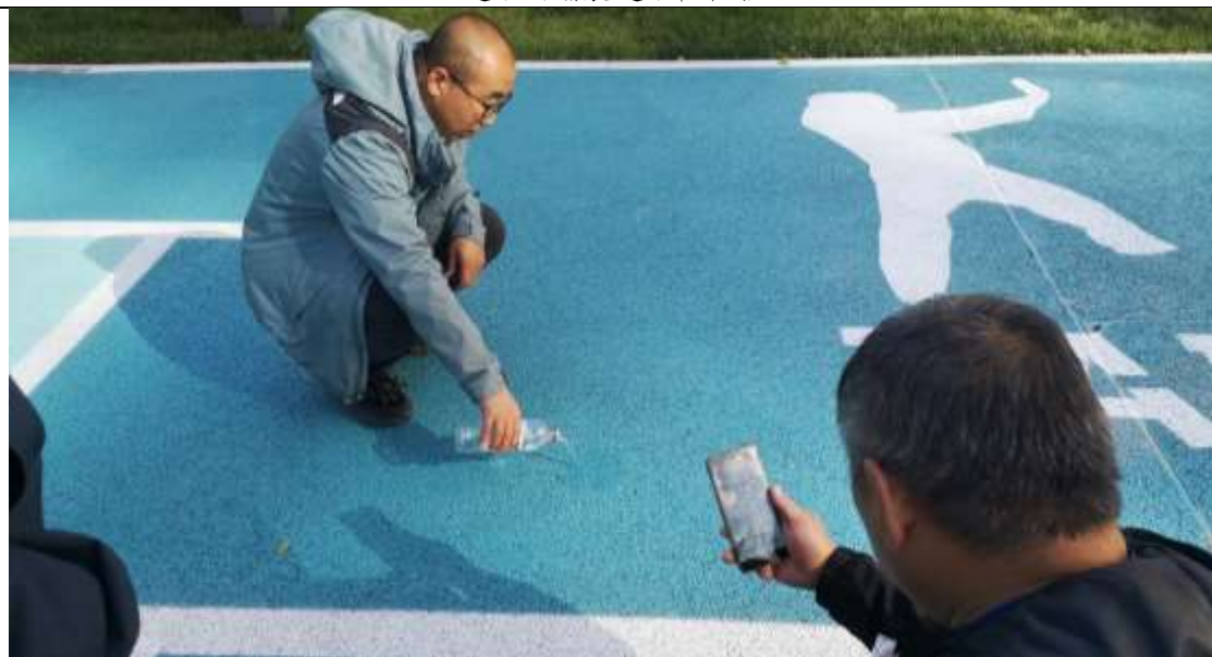
透水混凝土透水性检验
